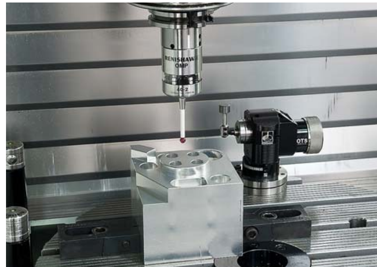
Meettasters kunnen in verspaningsmachines het werkstuk controleren, net als het gereedschap en de gereedschaphouder
